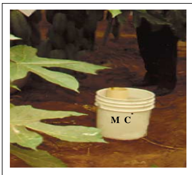
Figura 21. Instalación del lisímetro "MC".
