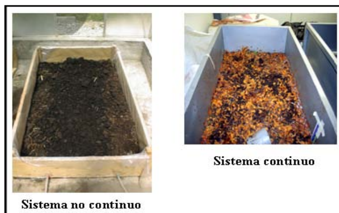
Figura 4. Dispositivos experimentales utilizados en procesos de vermicompostaje a escala piloto.
