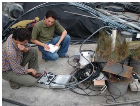
Figura 5: Sonda de capacitancia en una muestra de Andosol
